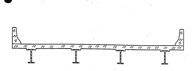
ROADWAY CROSS SECTION STEEL WIDE FLANGE BEAM
