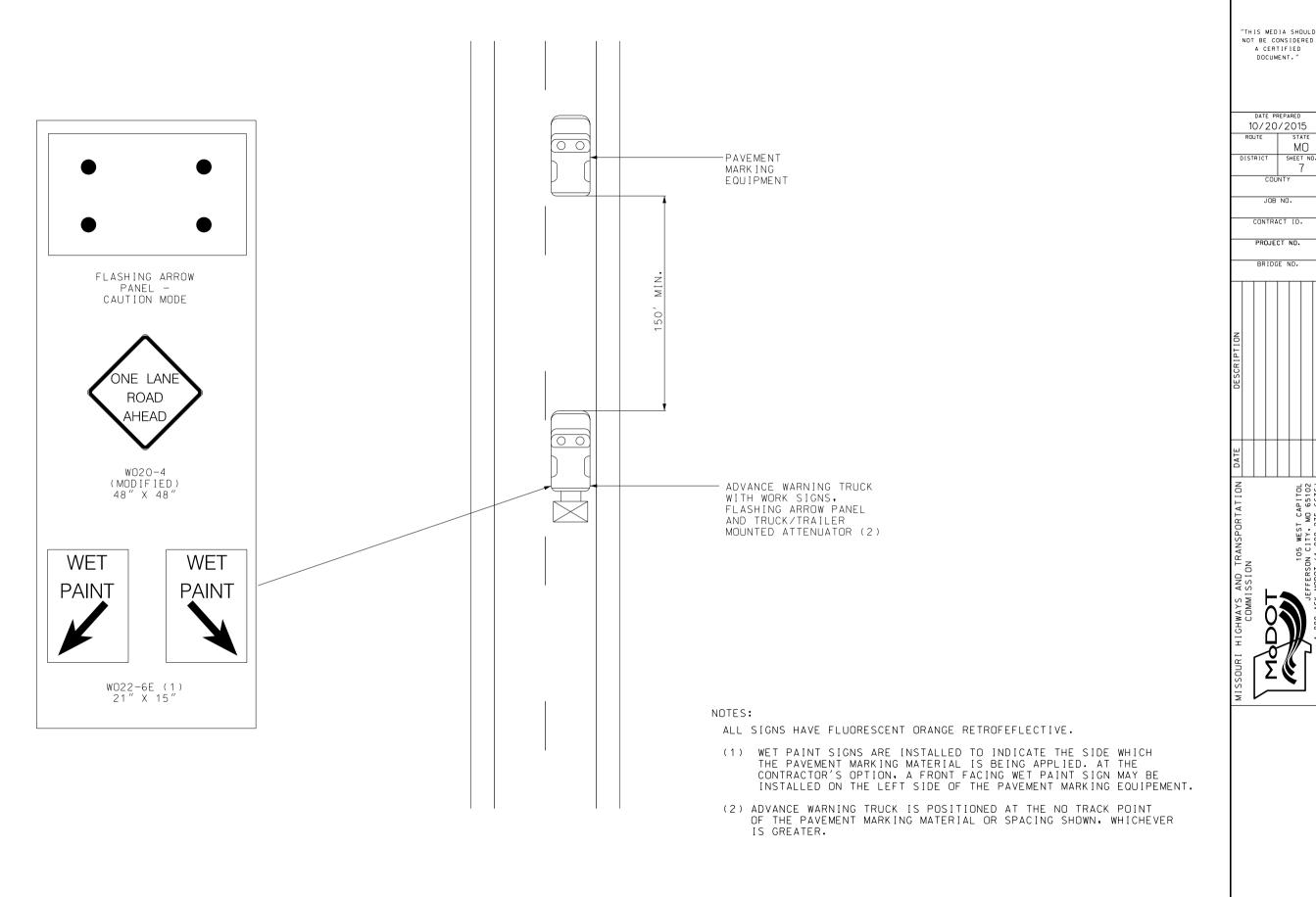
CENTERLINE/EDGELINE STRIPING ON TWO-LANE HIGHWAYS
