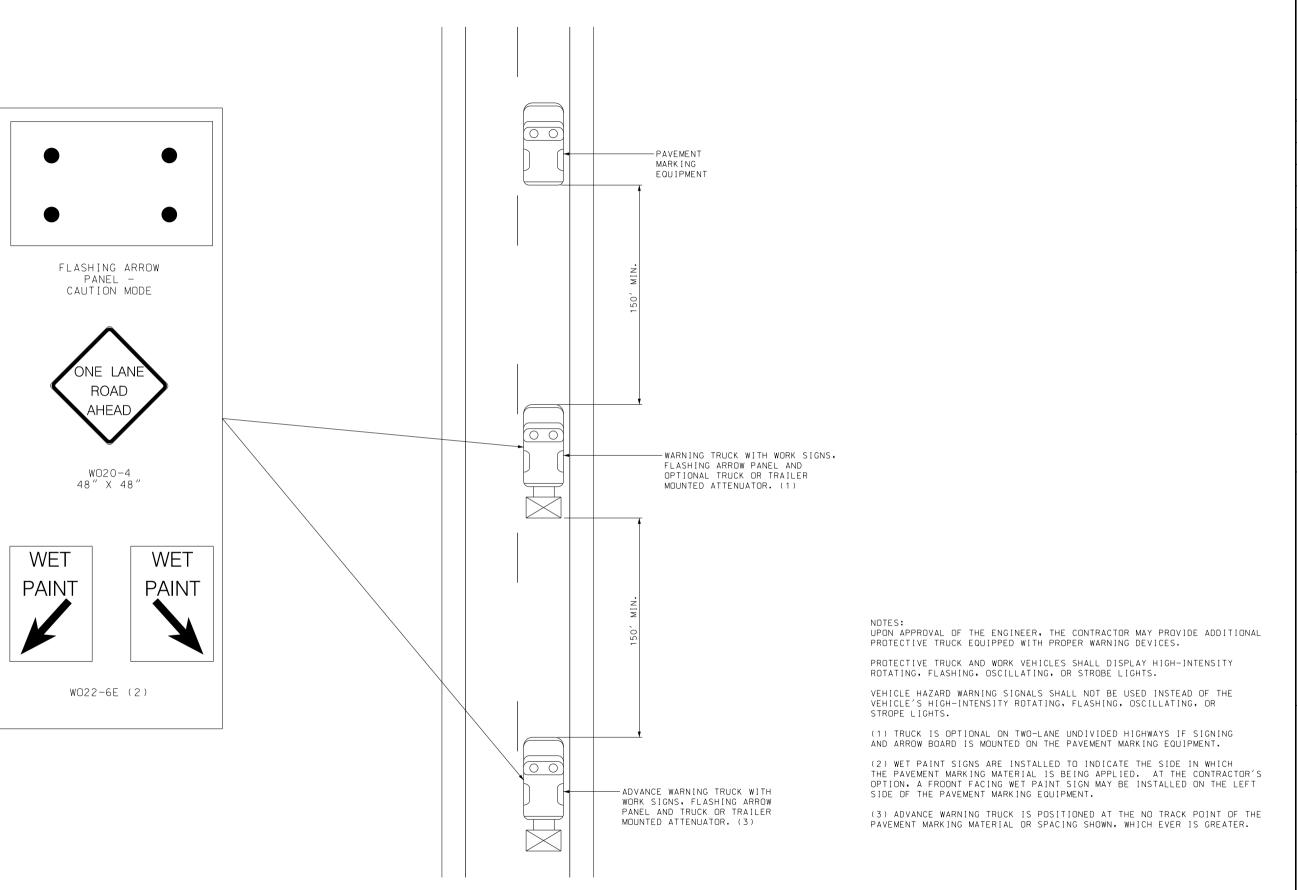
CENTERLINE/EDGELINE STRIPING ON TWO-LANE HIGHWAYS
